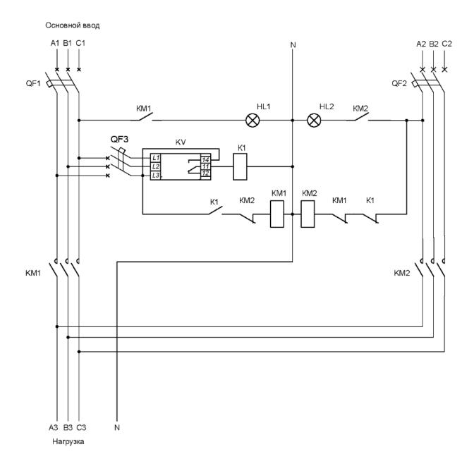
Схема щита аварийного переключения трехфазный номинальный ток 25А
