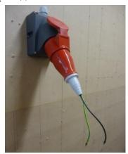
Подготовленные разъёмы соединяется с соответствующими разъёмами ЭУ. К полученным проводникам подключаются электроды мегомметра. Напряжение -250, 500B.
